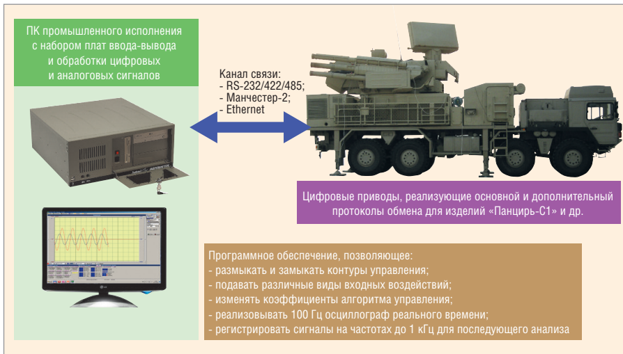
Рис. 2. Схема, иллюстрирующая организацию информационного обмена при совместной работе АСК и ПНС объекта
